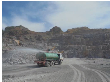
รูปที่ 2-11: การฉีดพรมน้ำบริเวณหน้าเหมือง
